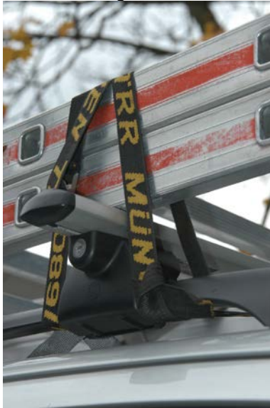
Bild: Sicherung einer Dachlast
