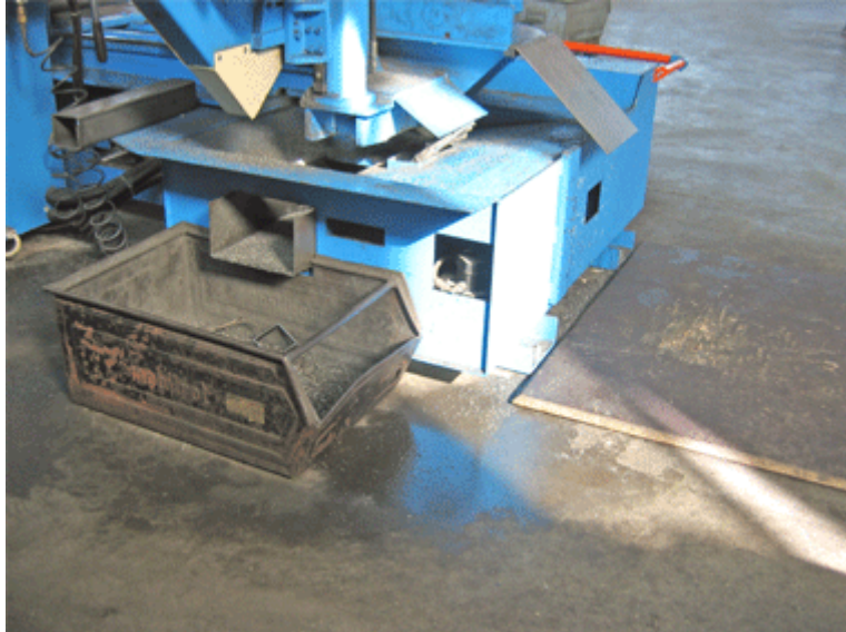
Bild: Verunreinigung mit Kühlschmierstoffen
