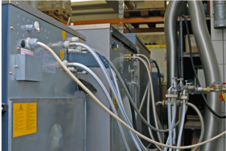
Bild: Kalt- und Warmwasseranschluss
