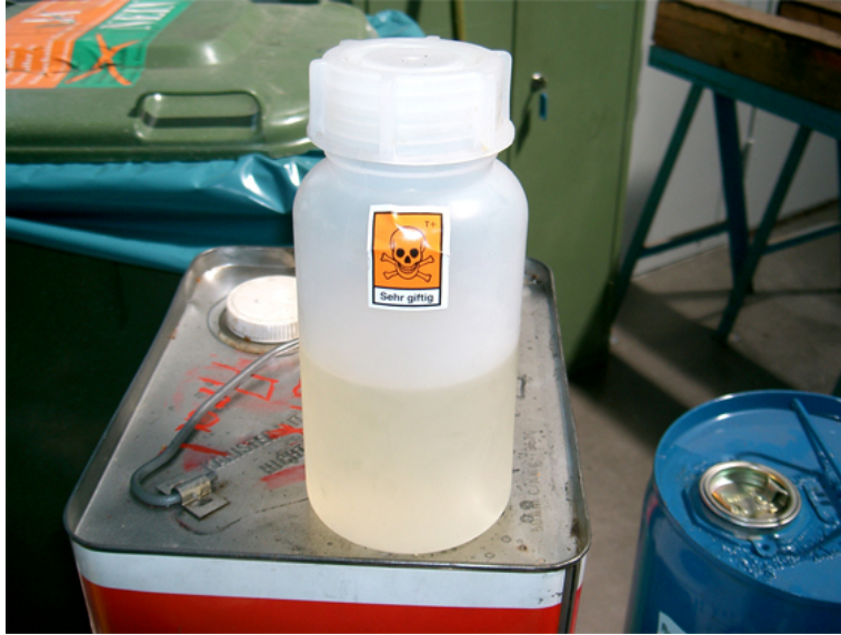
Bild: Fehlender Produktaufkleber auf Gefahrstoffgebinde
