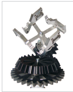
Bild 2: Satellit mit Werkstückaufnahme und Werkstücken
