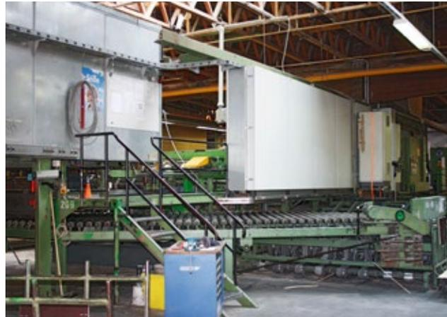
Durch das neue Furnierschnittverfahren am Trockenclipper realisiert das Unternehmen eine Verbesserung der Rundholzausbeute von 2,5 Prozent.
